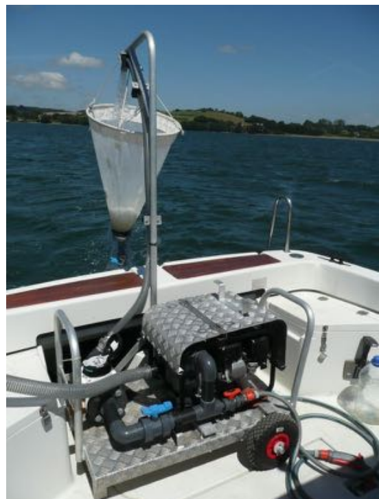
Figure 5 : Système de pompage et de filtration permettant la récolte des échantillons de plancton contenant les larves d'huîtres. La moto-pompe permet de filtrer 1,5 m 3 d'eau de mer en moins de 15 minutes. La maille du filet à plancton est de 40 µm. La mesure précise du volume pompé est fournie par un débitmètre. La crépine de prélèvements est lestée de manière à prélever à 1 mètre sous la surface. Lors du pompage, le bateau fait route au ralenti (vitesse inférieure à 1 nœud). Après pompage, le culot de filtration est transféré dans un flacon plastique de 2 litres tout en rinçant le filet. L'échantillon est formolé ou alcoolisé. Photo : © Cochet-environnement (2009). ►
