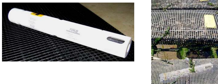
Figure 5 : Sondes d'enregistrement de type SP2T/STPS positionnées dans les poches ostréicoles
