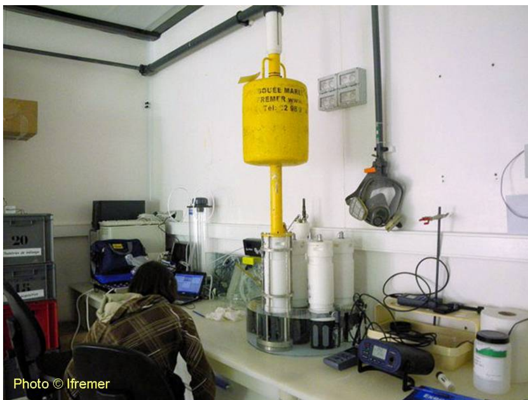
Photo 1 : Calibration des sondes Smacth d'enregistrement HF (station d'Argenton)
