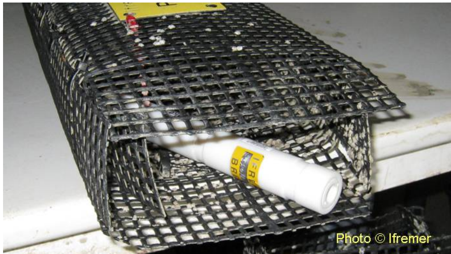
Photo 2 : Sonde d'enregistrement HF à lecture différée positionnée en poche ostréicole
