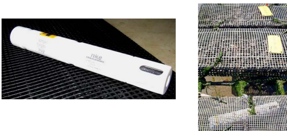
Figure 7 : Sondes d'enregistrement de type SP2T/STPS positionnées dans les poches ostréicoles
