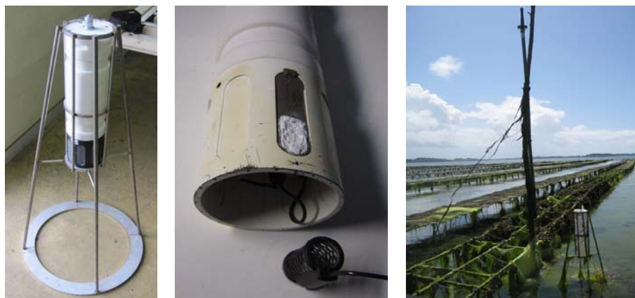
Figure 5 : Positionnement des sondes SMATCH sur le terrain A) bâti inox pour positionnement vertical B) grille de chloration et capot fermé C) positionnement sur le terrain à proximité des poches d'huîtres
