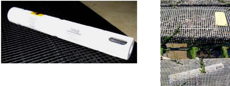
Figure 6 : Sondes d'enregistrement de type SP2T/STPS positionnées dans les poches ostréicoles
